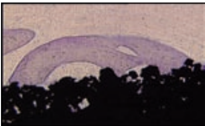
Bone in-growth on Porous Coating Integrazione ossea su rivestimento poroso
